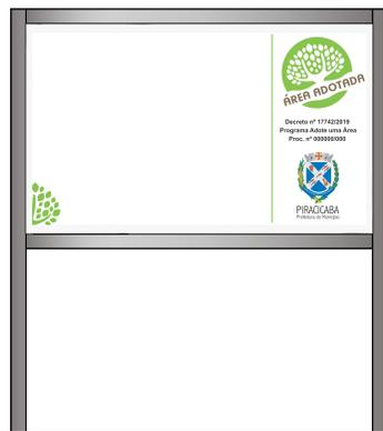
Placa em chapa galvanizada 16 tipo bandeja embutida na estrutura de metalon e fixada em quadro de cantoneira por arrebites de alumínio lateral.
